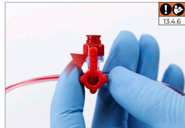
Aprire lentamente il serbatoio a 3/4 di giro (270°) in senso antiorario e richiederlo nuovamente in senso orario.
