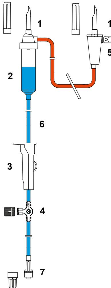
5. Das im Spike integrierte hydrophobe 0,2 µm Filter stellt eine sterile Belüftung sicher und verhindert Aerosolbildungen.
